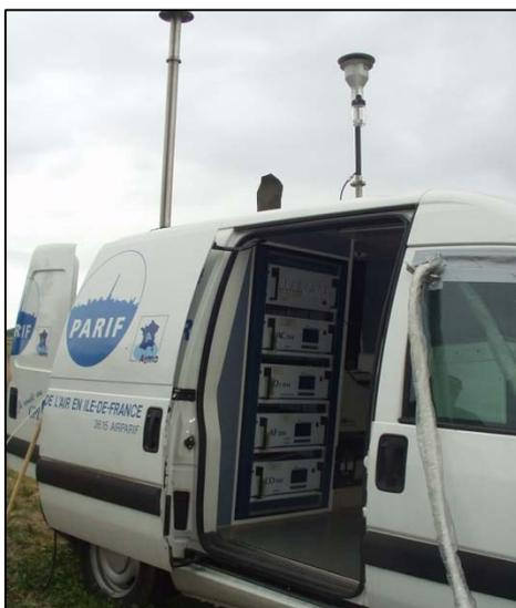
Figure 2 : Exemple d'un laboratoire mobile accueillant des analyseurs permettant les mesures horaires de la qualité de l'air de manière automatique.
