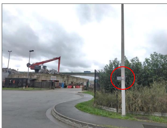
Figure 3 : Illustration des moyens de mesure installés lors de la campagne de mesure permettant la mesure de manière passive de l'empoussièrément, du NO 2 , BTEX, NH 3 et H 2 S
