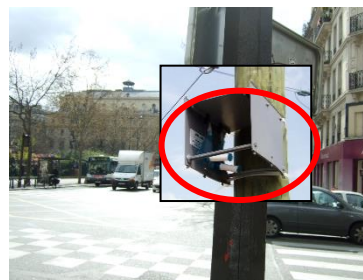
Figure 30 : Schéma d'implantation des tubes à diffusion passive de benzène C_6H_6 au sein de l'abri de protection
