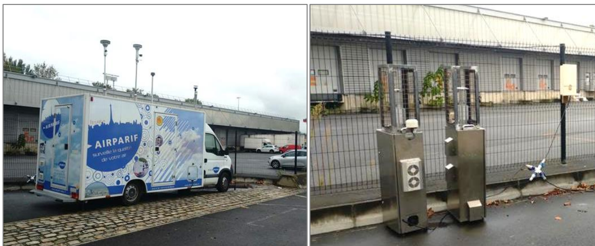
Figure 2 : Illustration d'un laboratoire de mesure installé lors de la campagne de mesure (Laboratoire de mesure 1 : mesures NO_2 et particules PM_{10} et PM_{2.5} ) et de préleveurs implantés sur les sites accueillant un laboratoire de mesure (mesures de HAP et métaux).
