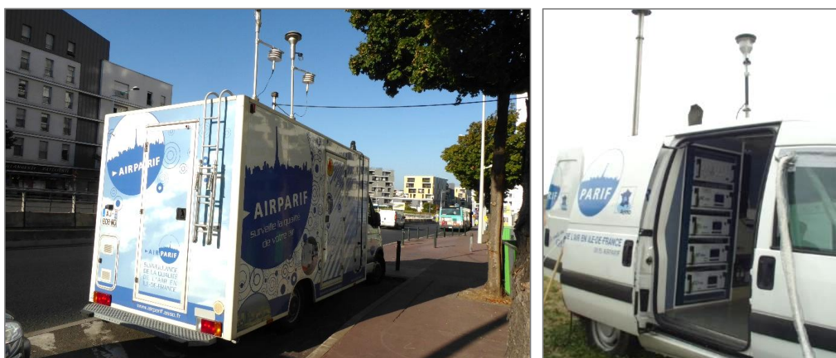
Figure 28 : Laboratoire de mesure et exemple d'un laboratoire de mesure accueillant des analyseurs permettant les mesures horaires de la qualité de l'air de manière automatique
