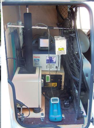
Suite à la première étude en voiture menée en 2007 (voir p.3), Airparif a de nouveau équipé un véhicule avec des appareils de mesure en 2008. Deux polluants ont été mesurés, toutes les 10 secondes : le dioxyde d'azote et les particules. Les mesures ont été menées pendant les heures de pointe, sur près de 300 trajets représentatifs des trajets domicile-travail régionaux.
