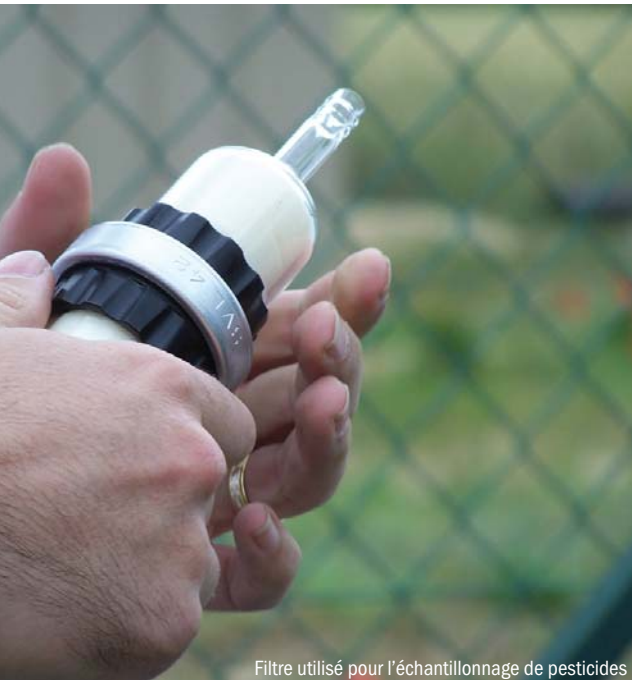
Filtre utilisé pour l'échantillonnage de pesticides
