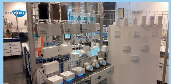
Test de différents microcapteurs en intérieur
